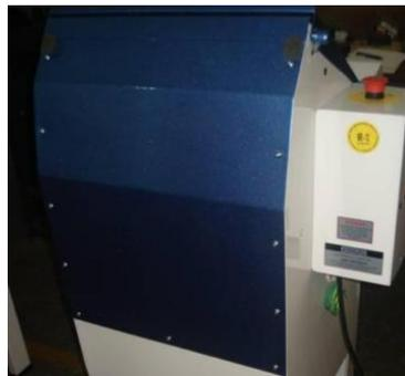
OBS: Em ensaios efetuados, a proteção móvel interrompe o motor com uma abertura mínima (vão de acesso), impedindo o acesso dos membros superiores à área de risco.
