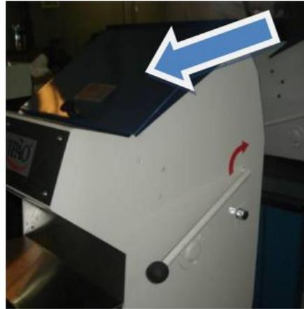
AREA DE AÇÃO DA FERRAMENTA - Alavanca do empurrador manual.
