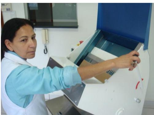
7. Solte a Alavanca. A Alavanca Movimenta o Empurrador, que é tracionado por uma mola interna. O Empurrador, então, pressionará Os pães contra as lâminas de corte.
