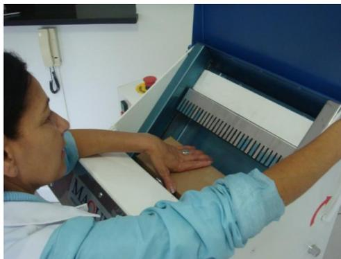
6. Posicione os pães na Área de Corte. O Primeiro pão deverá ser empurrado de forma a pressionar o Pente durante o corte.
